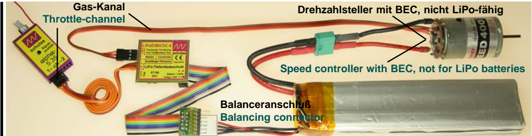
Verdrahtungsbeispiel 1 / Typical wiring arrangement 1
