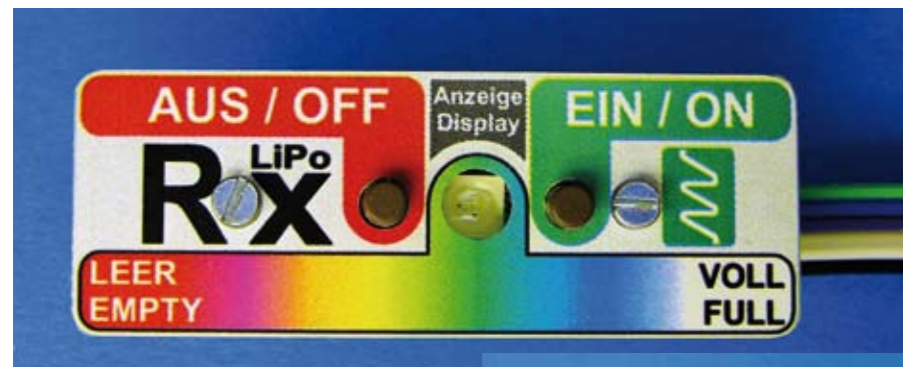
Mit sechs Farben (Rot, Violett, Gelb, Grün, Blau und Weiß) signalisiert der LiPoRXII zuverlässig den momentanen Akkufüllstand
