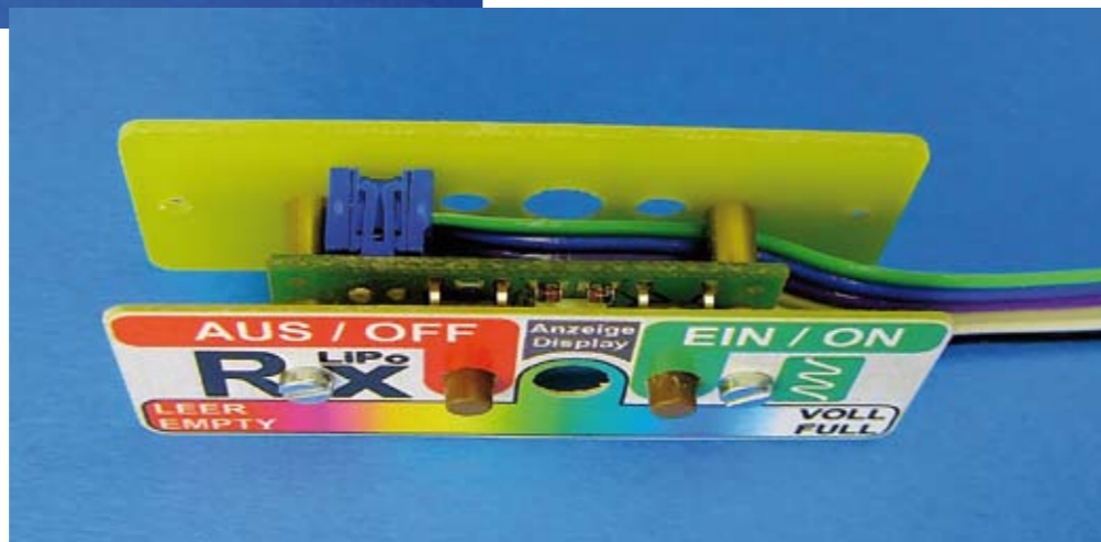
Montage der Front- und Rückplatte mit M2-Schrauben und Messing-Abstandsrohrechen aus dem Zubehörbeutel
